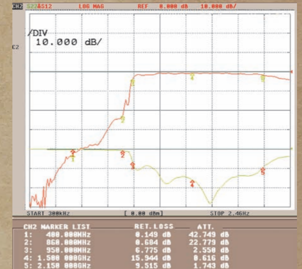
Respuesta y pérdidas retorno de la toma SAT A/F
