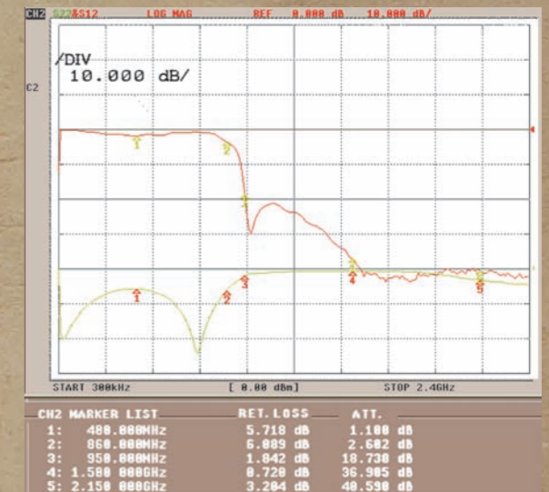
Respuesta y pérdidas retorno de la toma TV A/F
