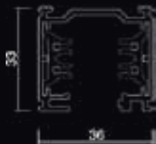
FD751110 3-Phase for recessed installation (1m) 3-х фазный шинопровод для открытой установки (1м) Carril superficie 3 encendidos (1m)
